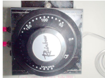
湿度空焚保护开关 位于机器配电盘上
